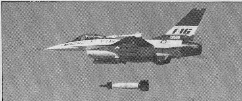
Tir d'une bombe planante à guidage laser « GBU 10 » par le M 16 équipé du pod de désignation « Atlis 2 » (sous l'entrée d'air droite).
