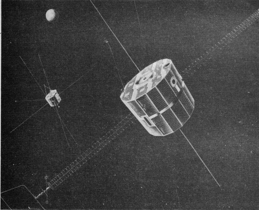
Configuration générale des satellites « Dynamics Explorer » en orbite après leur lancement en 1981. Le satellite « DE-A » (au premier plan) sera placé sur une orbite polaire 270-24 000 km, tandis que « DE-B » (au fond) gravitera sur une orbite polaire coplanaire plus basse, 270-1 200 km. Les satellites seront recouverts de photopiles et posséderont des batteries Ni-Cd pour l'alimentation de bord.
